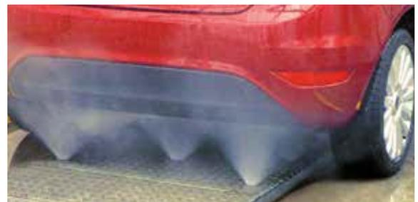
Si può scegliere tra lavaggio sottoscocca fisso 10 bar, 90 L/min, oscillante 15 bar, 120 L/min o a settori 15 bar, 120 L/min.
